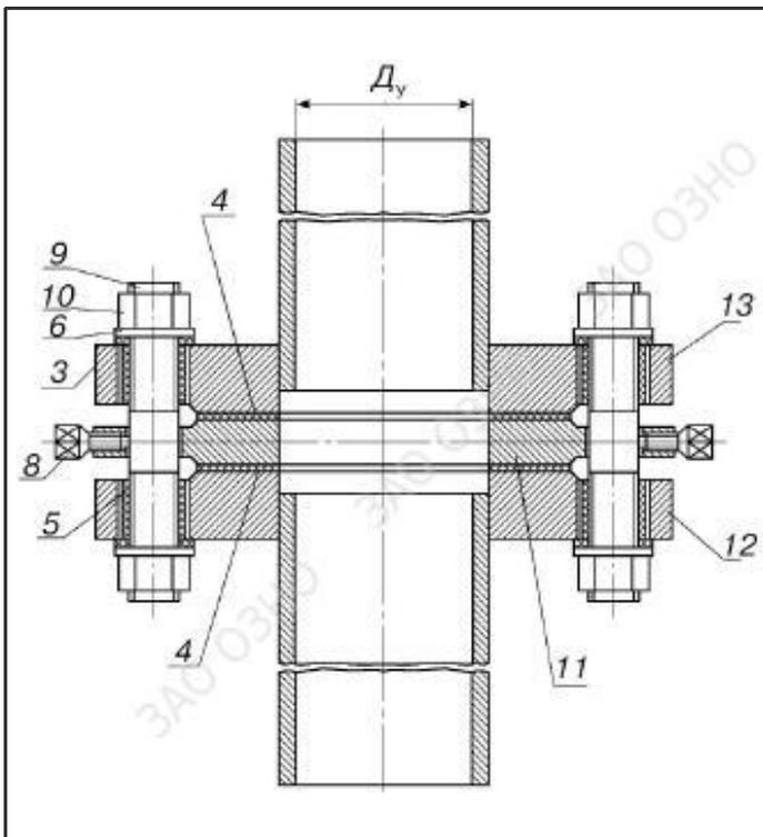
Изолирующее фланцевое соединение состоит двух основных фланцев 12 и 13, приваренных к концам газопровода, имеется третий специальный фланец 11 толщиной 16-20 мм.
